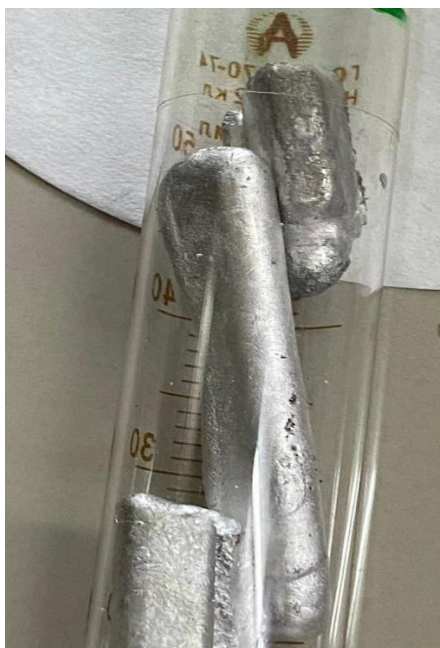
Рисунок 2 – Внешний вид слитка активированного сплава алюминия
